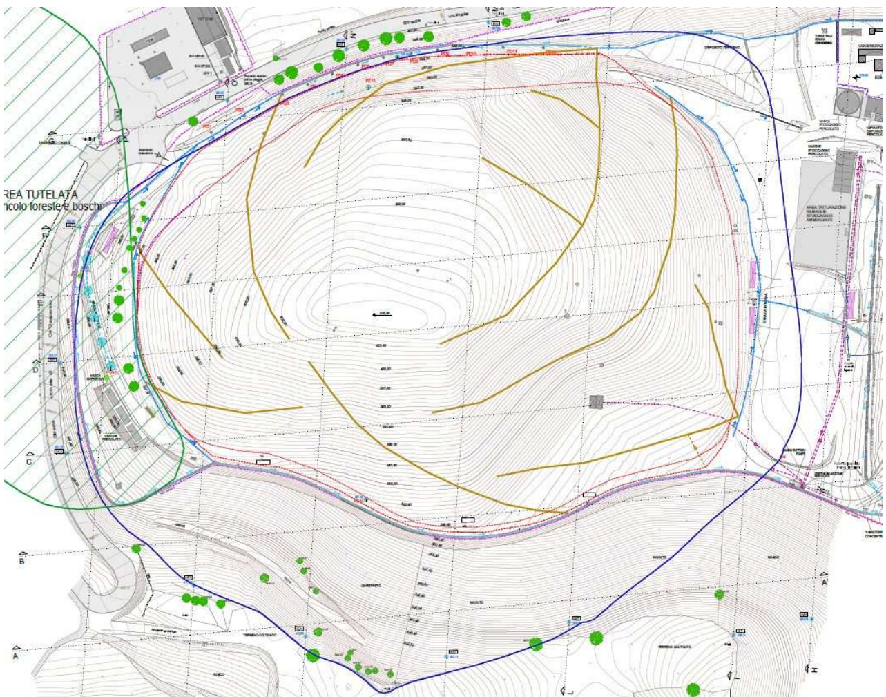
Figura 9: rete di drenaggio delle acque superficiali
