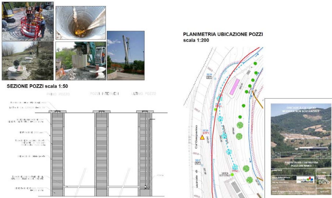
Figura 17: pozzi drenanti a monte
