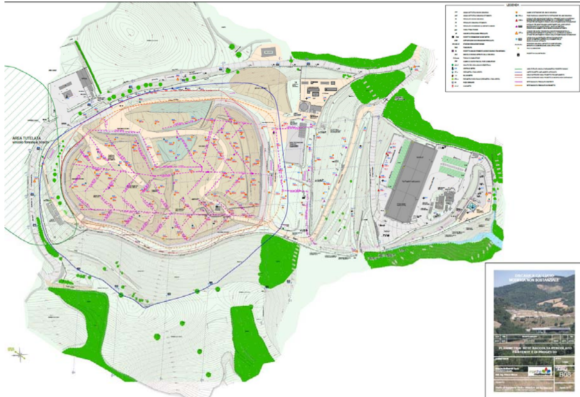
Figura 14: rete di drenaggio del percolato
