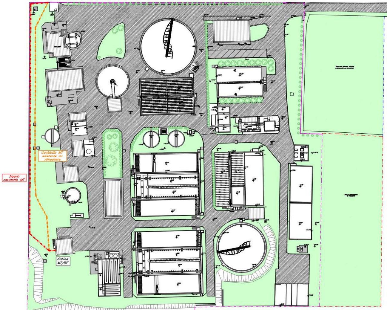
Figura 5: Planimetria dello stato attuale con indicati i tracciati del cavidotto MT esistente da dismettere (in arancione) e di quello di nuova realizzazione (in rosso)
