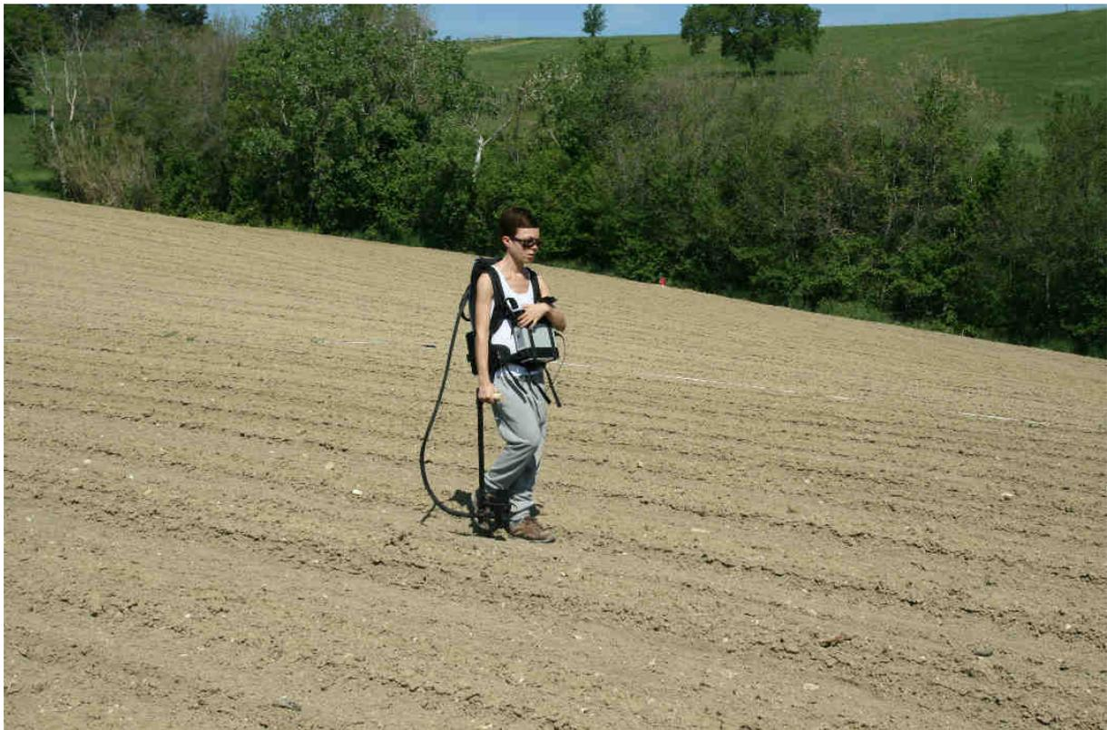
Figura 17. Indagini magnetiche con magnetometro GEM Systems GSMP-35 presso l'area della discarica.
