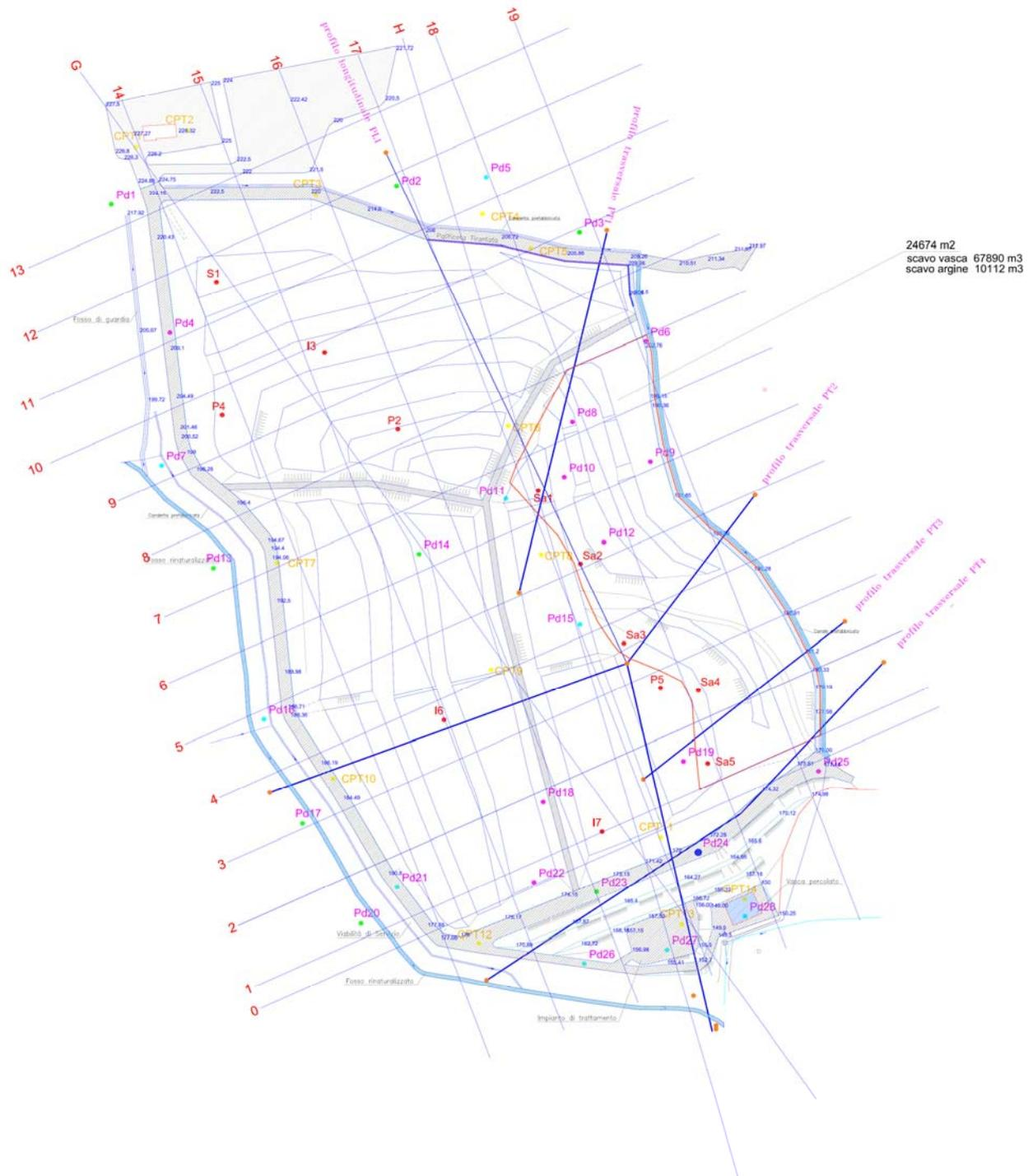
Figura 2 - Planimetria generale dell'area di ampliamento della discarica di Corinaldo, con ubicazione delle verticali di indagine della campagna geognostica i cui risultati sono esposti nella Relazione Geologica e Geotecnica del dott. geol. Pieramelio Baldelli. (non in scala).
