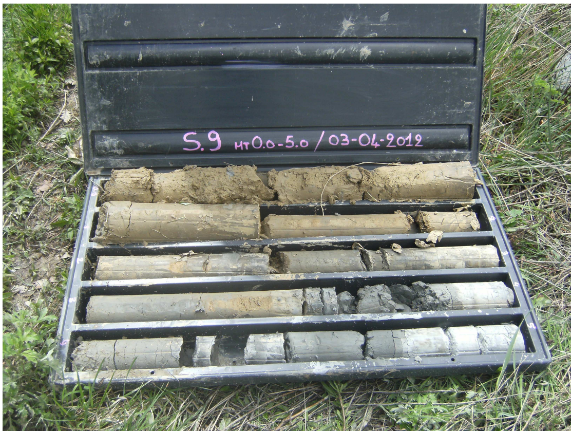
FOTO 3 : Sondaggio n. 9 da 0-5m
