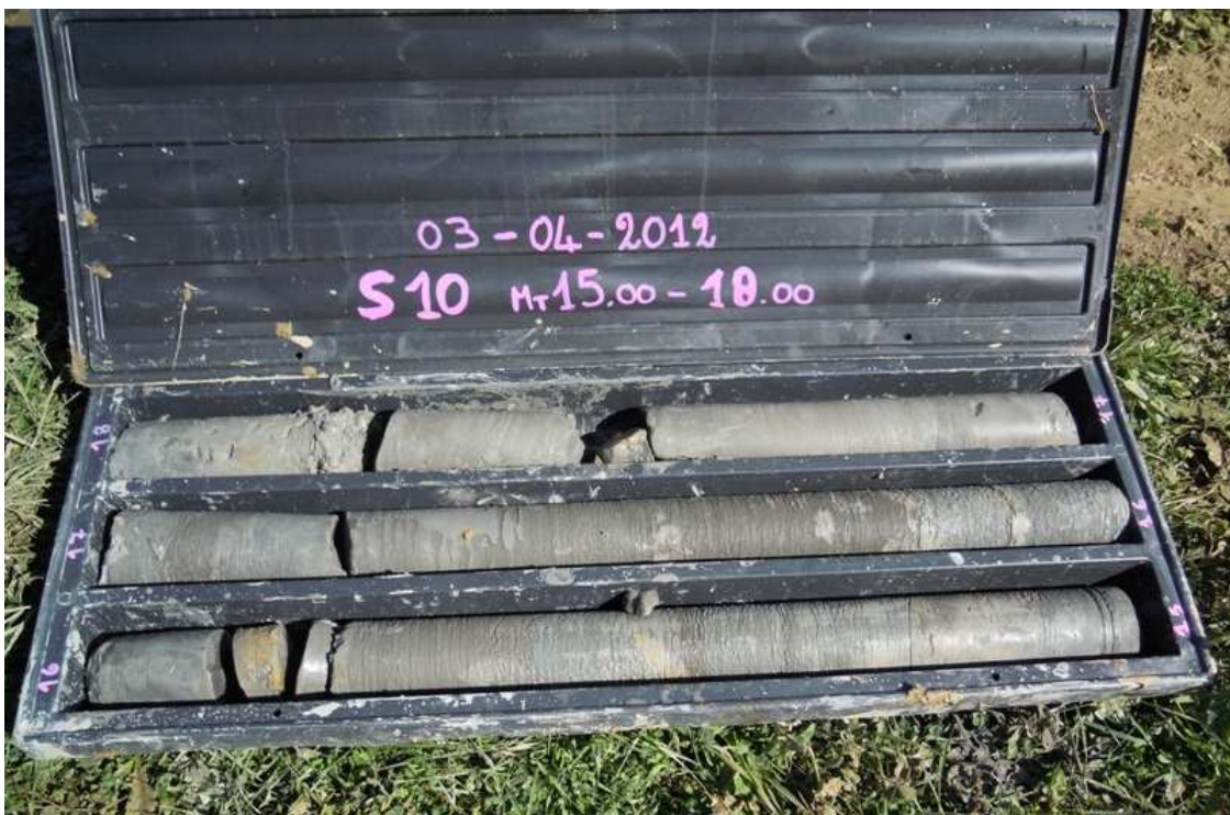
FOTO 12 : Sondaggio n. 10 da 15-18m
