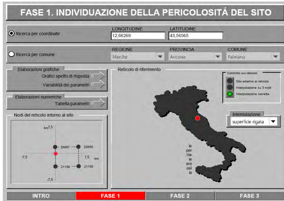
Fig. 6 - Spettri NTC.vers 1.0.3 - definizione dei parametri sismici
