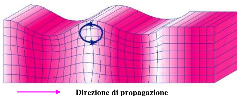
Fig. 2 - Rappresentazione grafica della propagazione delle onde superficiali di Rayleigh caratterizzata dall'oscillazione polarizzata in un piano verticale e con movimento delle particelle retrogrado rispetto al senso di propagazione dell'onda.
