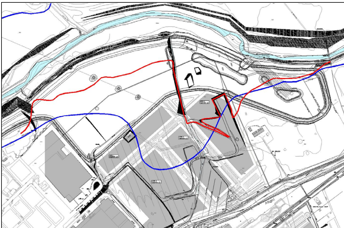
Figura 23: Stima del limite di esondazione relativo ad un evento duecentennale sull'attuale andamento topografico del terreno (ROSSO – sponda destra) rispetto alla perimetrazione PAI (BLU)
