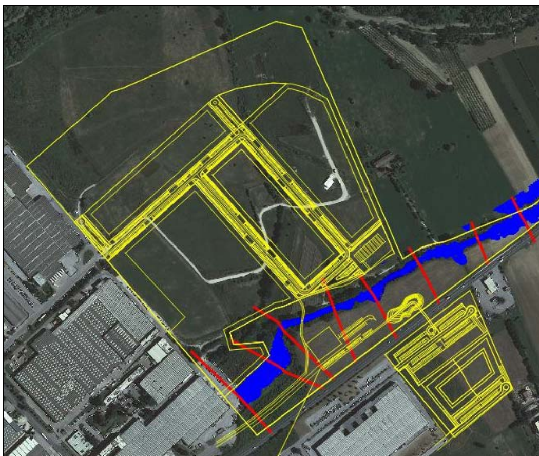
Figura 61: Aree esondabili lungo il Vallato con tempo di ritorno 200 anni - scenario stato di progetto
