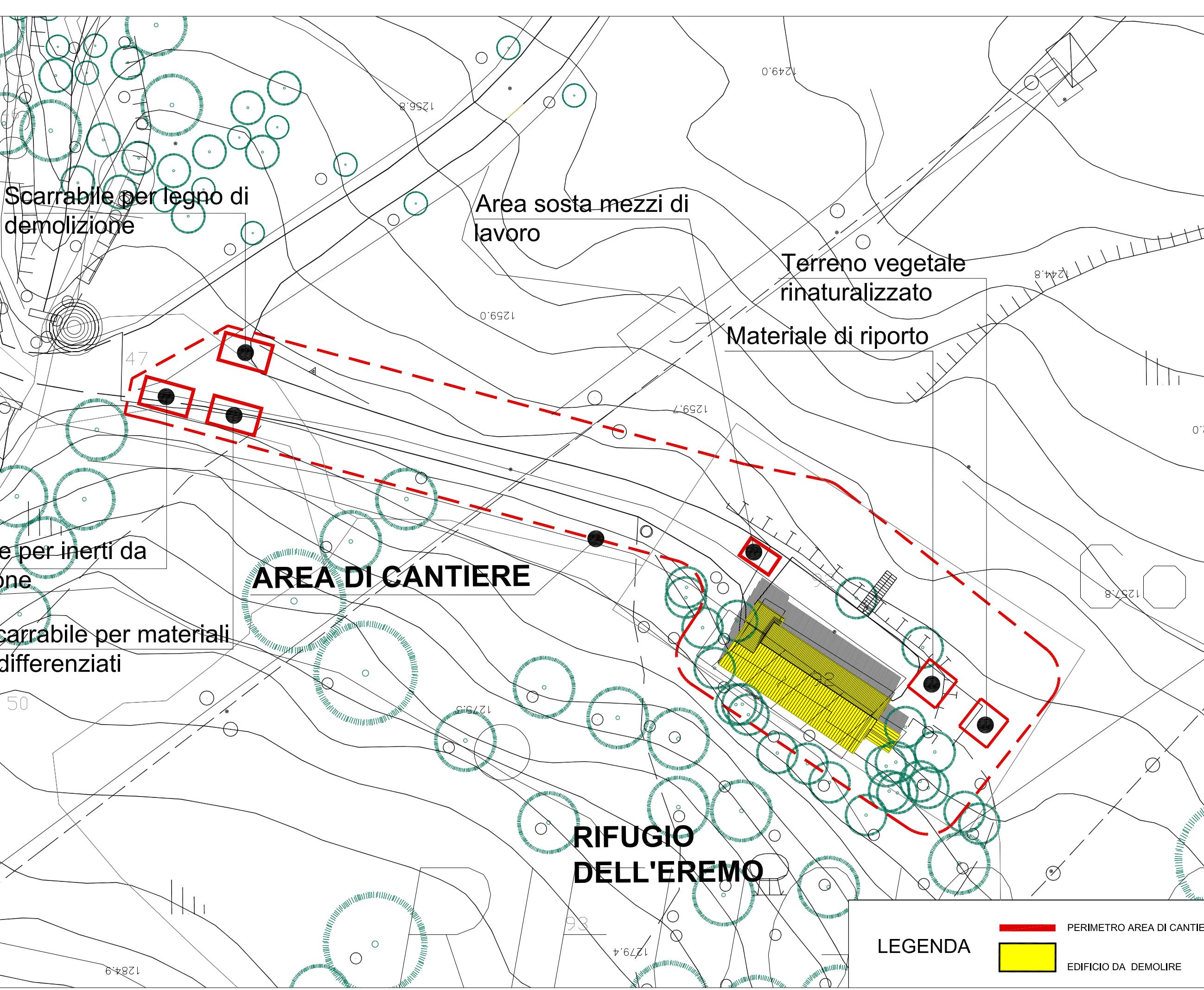
Seconda fase, demolizione edificio Rifugio Eremo, interventi di rinaturalizzazione e compensazione - planimetria scala 1:500
