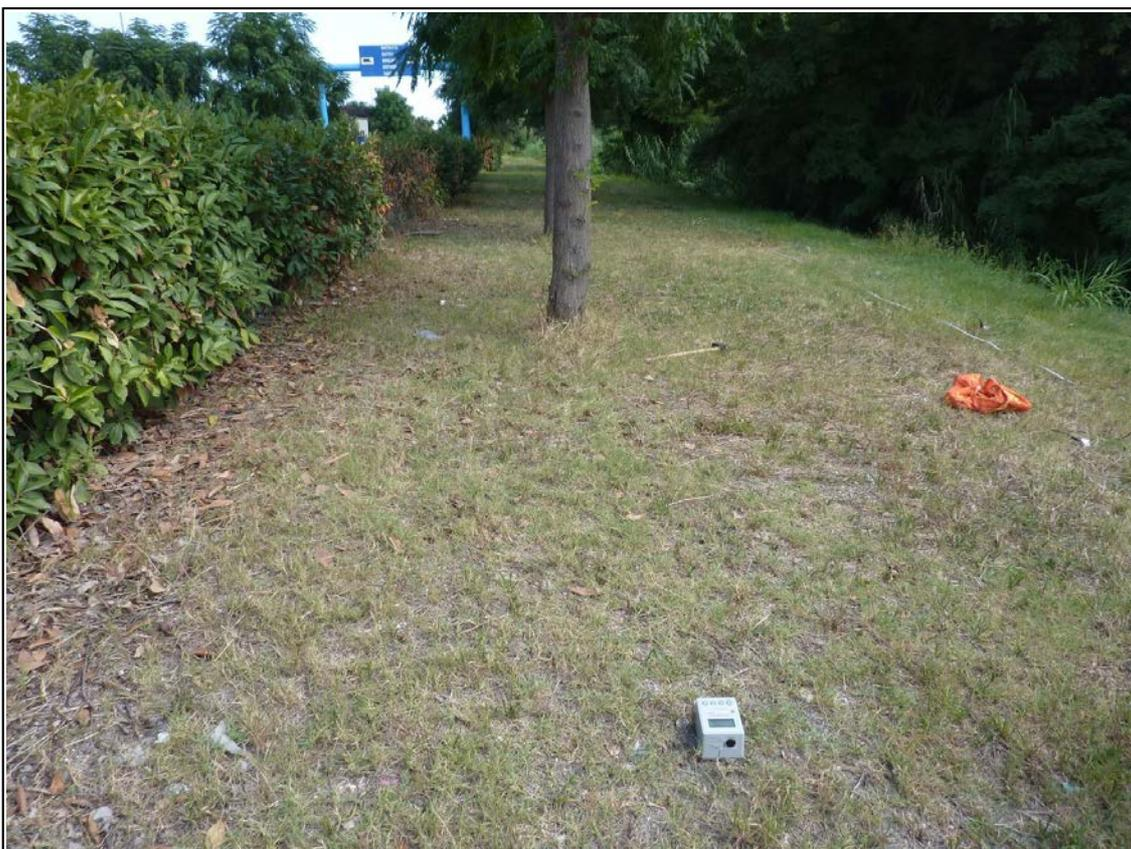
Figura 4.1 – Indagine HVSR congiunta a MASW/REMI effettuata nella zona industriale di Bellocchi di Fano (sito Profilgrass; foto Bisiccia).
