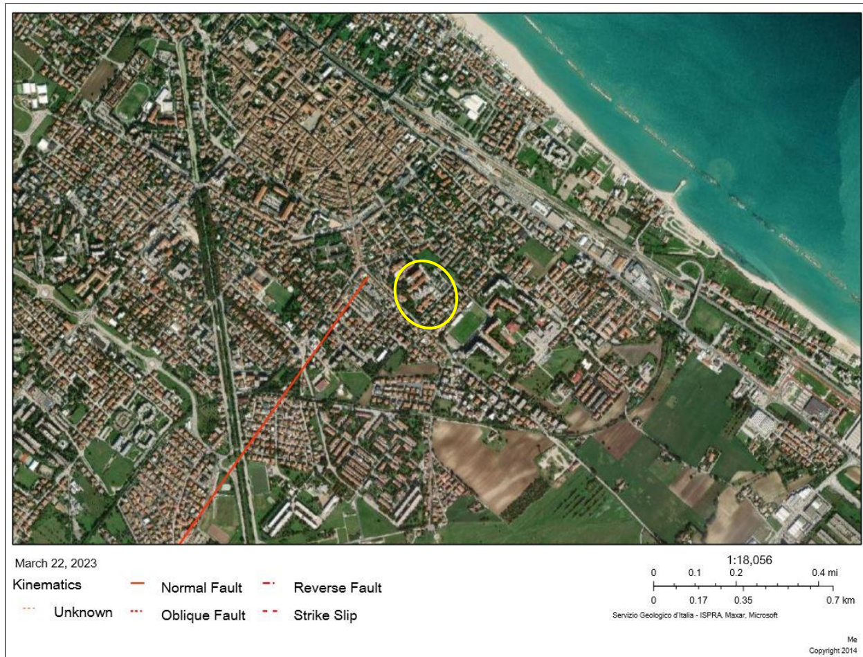
Figura 4.1 Immagine tratta dal Database ITHACA ( Michetti et al., 2000 ; http://sqi2.isprambiente.it/ithacaweb/viewer/ ) che mostra le faglie attive e capaci censite nella regione che include il sito d'interesse, indicato dal simbolo giallo
