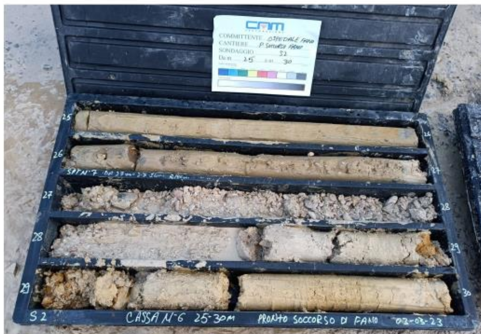
Figura 3.12 Cassette catalogatrici relative al sondaggio S2 (profondità da 20 a 30 m dal p.c.)
