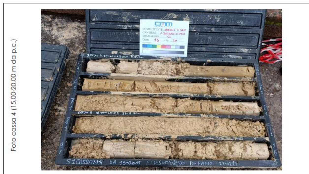
Figura 3.6 Cassette catalogatrici relative al sondaggio S1 (profondità da 10 a 20 m dal p.c.)
