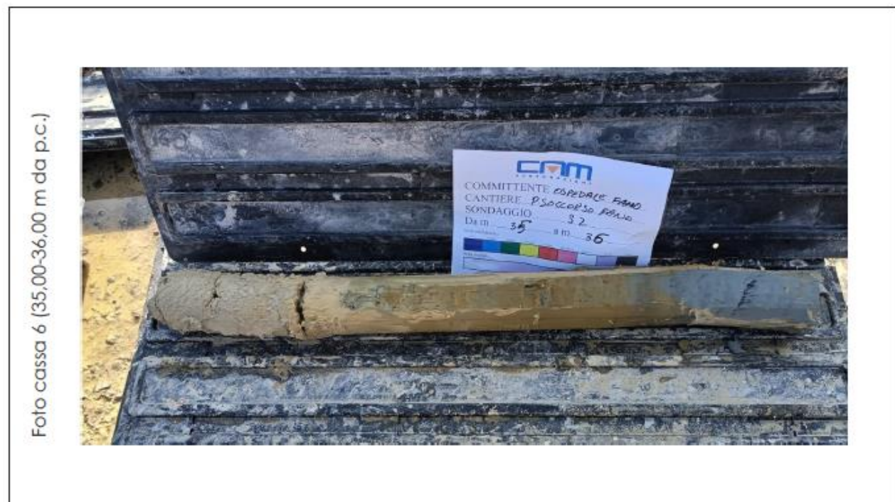
Figura 3.13 Cassette catalogatrici relative al sondaggio S2 (profondità da 30 a 36 m dal p.c.)
