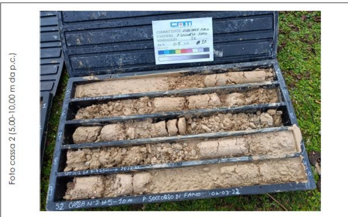
Figura 3.10 Cassette catalogatrici relative al sondaggio S2 (profondità da 0 a 10 m dal p.c.)
