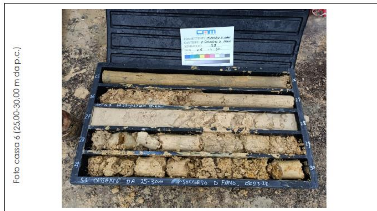
Figura 3.7 Cassette catalogatrici relative al sondaggio S1 (profondità da 20 a 30 m dal p.c.)
