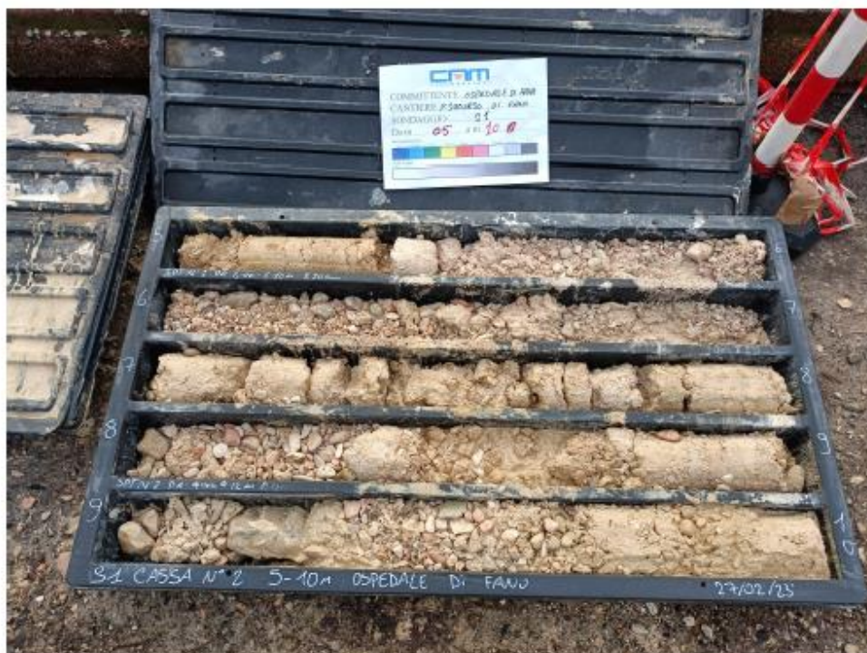
Figura 3.5 Cassette catalogatrici relative al sondaggio S1 (profondità da 0 a 10 m dal p.c.)
