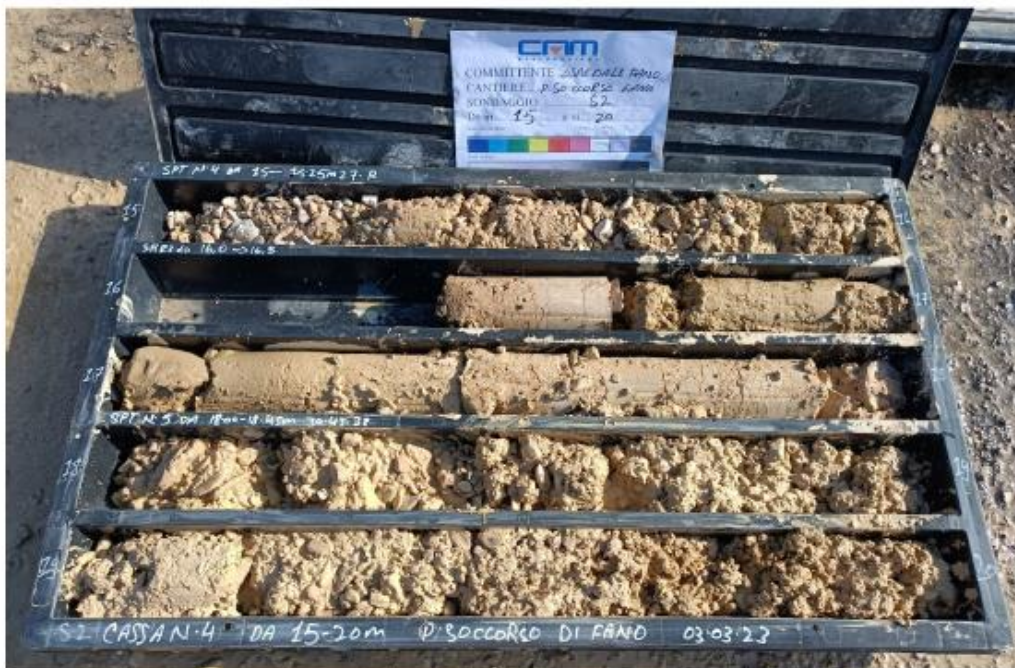
Figura 3.11 Cassette catalogatrici relative al sondaggio S2 (profondità da 10 a 20 m dal p.c.)
