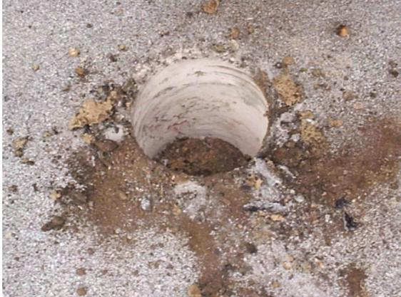
Particolare del foro di perforazione del sondaggio S1 - 2007 (Trivelsonda) - calcari rosati della Scaglia Rossa
