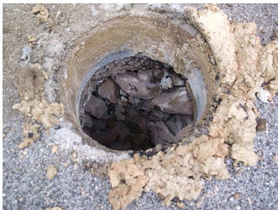
Particolare del foro di perforazione del sondaggio S2 - 2007 (Trivelsonda) - riempimento a tergo del muro con scarti di cava (frammenti di Scaglia Rossa)
