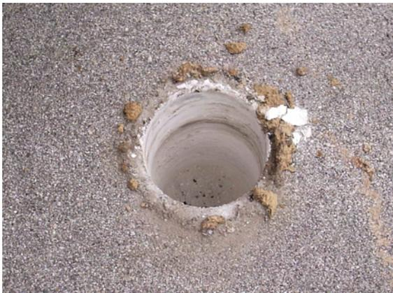
Particolare del foro di perforazione del sondaggio S3 - 2007 (Trivelsonda) - calcari rosati della Scaglia Rossa
